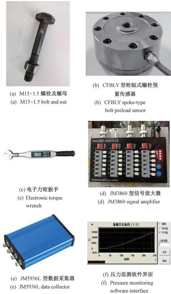
图 9 实验设备示意图 Fig. 9 Schematic diagram of test equipment
